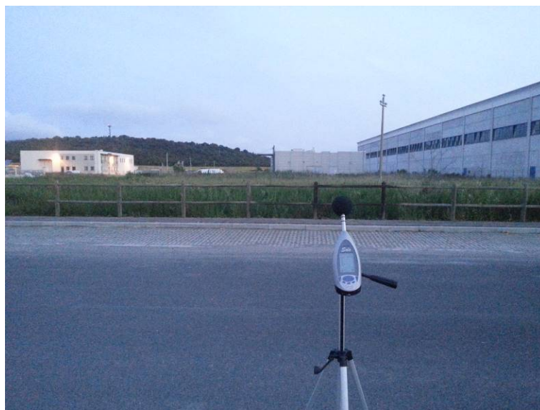
Foto 4: Postazione per le misure notturne di taratura (la foto è stata fatta all'alba per visualizzare meglio la posizione)
