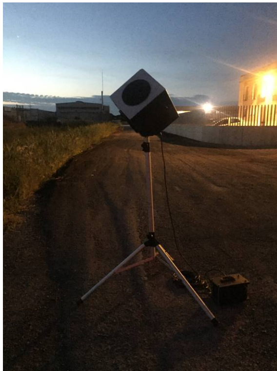
Foto 3: Sorgente Isotropica utilizzata per le misure notturne, per tarare il Modello di Simulazione (la foto è stata fatta all'alba per visualizzare meglio la posizione)
